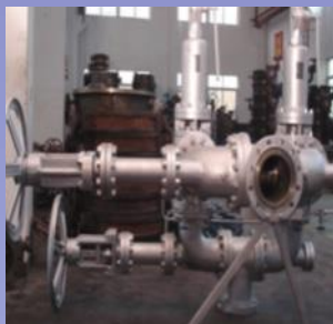
СППК, карданная передача (ресурс 24-38 мес.)
