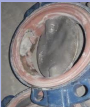
Дисковый затвор, угл. сталь + полиуретан (ресурс 7-10 дней)
