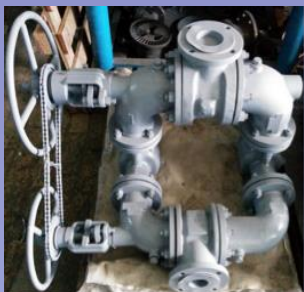
СППК, цепная передача (ресурс 6-12 мес.)
